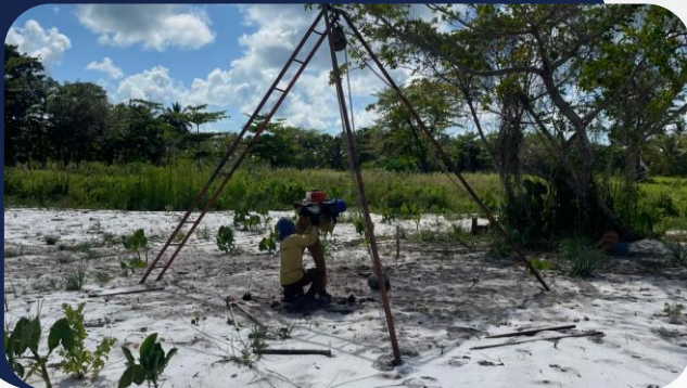
Foto 2: Sondagem do terreno
