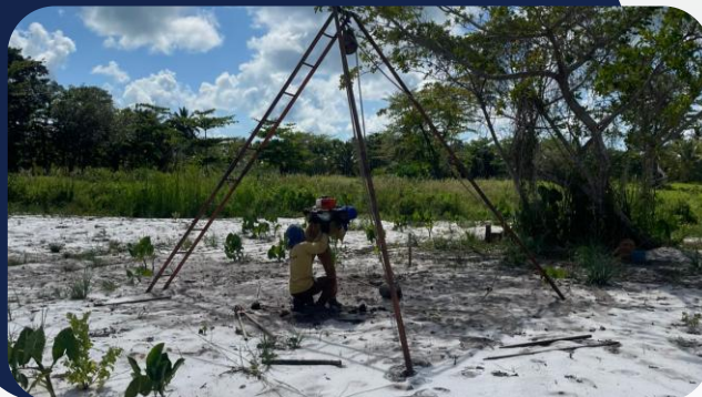
Foto 2: Sondagem do terreno
